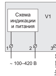
Схема 1. Упрощенная внутренняя схема и схема подключения
