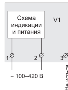
Схема 1. Упрощенная внутренняя схема и схема подключения
