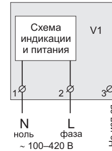
Схема 1. Упрощенная внутренняя схема и схема подключения
